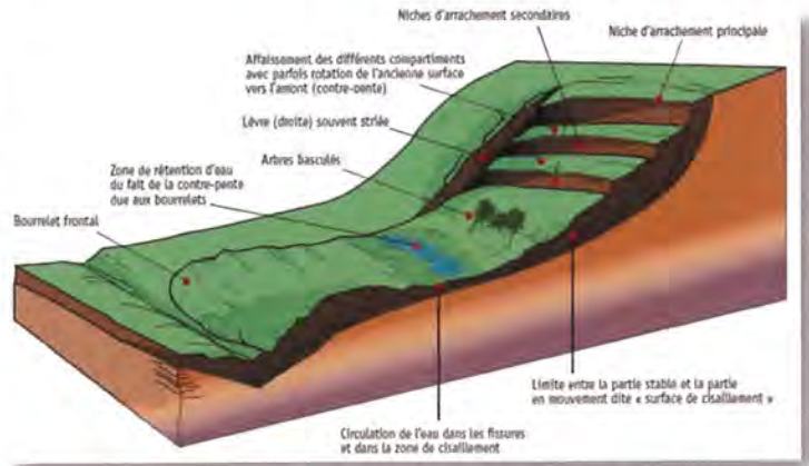
Schéma en coupe d'un glissement de terrain © A. Fric
